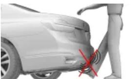
Entfall berührungslose Betätigung Heckklappe (S032X)
