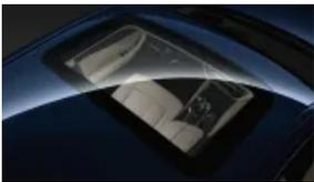
Glasdach, elektrisch mit Schiebe- und Hebefunktion
